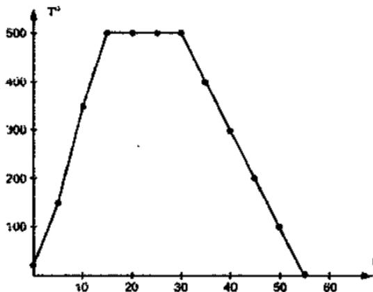
Из графика видно, что в течение 15 мин сталь нагревается от 20 до 500 °С. В течение следующих 15 мин температура стали постоянна и равна 500 °С. Затем в течение 25 мин сталь охлаждается до 0 °С.
